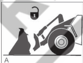
A Padargo laikiklio fiksavimo kaiščiai neužrakintoje padėtyje
