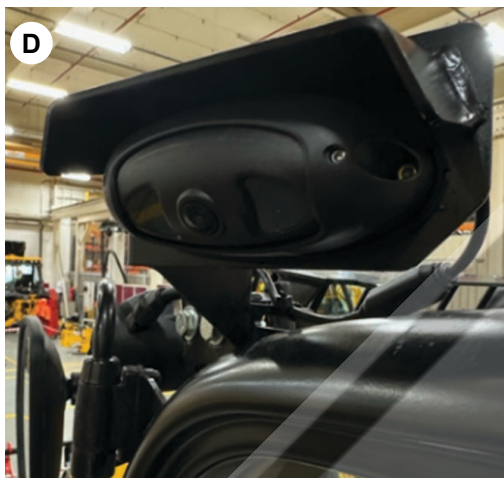
43 Paveikslas. Į priekį nukreipta kamera ir kabinos viduje esantis garsiakalbis, sumontuoti už ekrano
